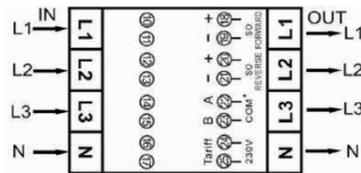
Ist der Zähler, das letzte Gerät im Bus, muss dieser zusätzlich über die Klemme 22 und 23 mit einem (120 Ohm / 0,25W) Widerstand terminiert werden.
